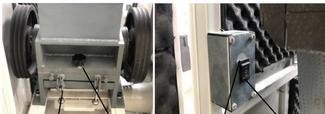
Винт с фиксатором модуля Средний винт
