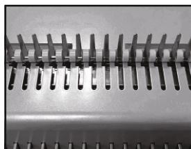
Поместите пластиковую пружинку за металлическую гребенку так, чтобы открытая часть пружинки была обращена к вам.
